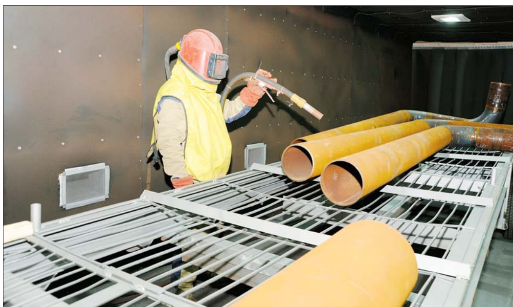
С помощью специальной обработки пескоструйщик Рамис Гараев очищает трубы от ржавчины и коррозии.
